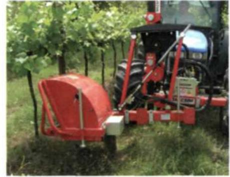
Tutte le versioni possono essere applicate anteriormente o posteriormente alla trattoria e sulla colonna Trimmer. Possono inoltre montare sia rotori con fili di nylon che a tondino di poliuretano ad alta resistenza.
