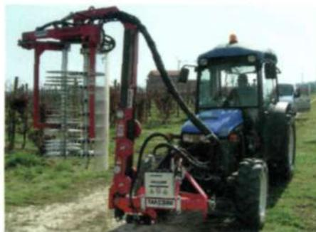
L'apertura sul palo è automatica a comando idraulico così come è automatico il posizionamento perpendicolare al terreno. È inoltre dotata di movimento idraulico di brandeggio anteriore, regolazione laterale secondo l'inclinazione del filare e ammortizzatore laterale. La potatrice viene montata su colonna Trimmer anteriormente al trattore.
