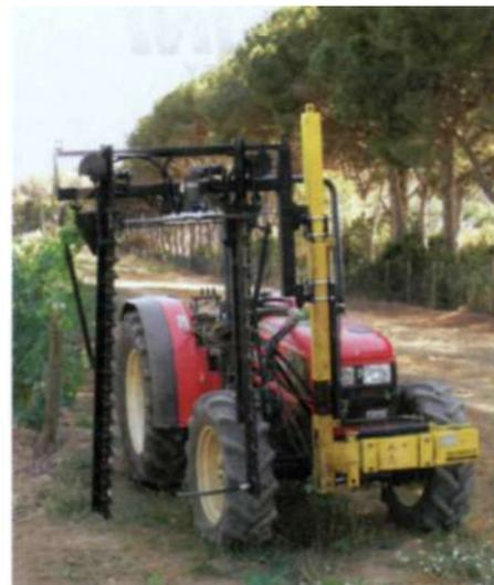
Di tipo scavallante, è dotata di due spostamenti idraulici e di elettrovalvole chiusura flusso.
