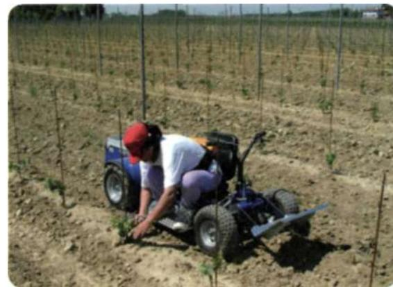
Lunghezza di 1.550-2.000 mm, larghezza di 690-800 mm e altezza di 100 mm, pesa 196-220 kg. Il motore elettrico è da 24 V, 600-800 W, trasmissione a ingranaggi in bagno d'olio. Il carica batterie è esterno. La portata è di 150-300 kg.
