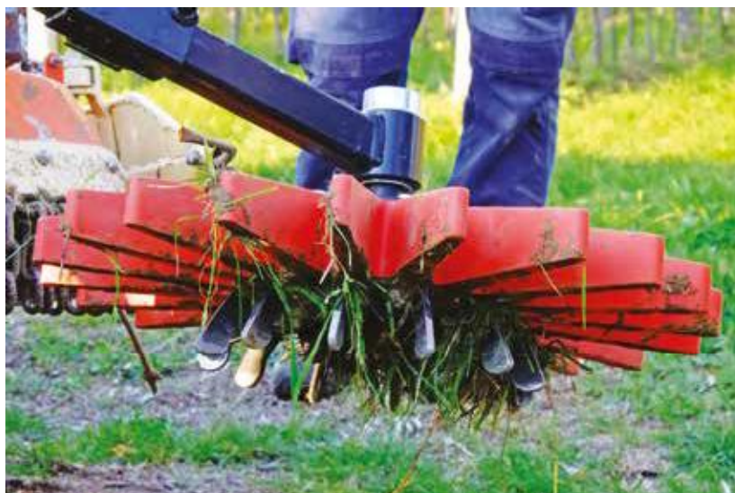
"IL DISCO ROTANTE A DITA: SI NOTINO AL DI SOTTO GLI SPERONI IN ACCIAIO CHE GARANTISCONO LA ROTAZIONE."
