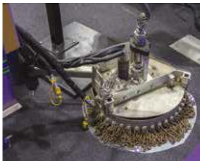
“LA TESTA DI LAVORO DELLA ATTILA È DOTATA DI UGELLI IN GRADO DI SOPPORTARE L'ALTISSIMA PRESSIONE GENERATA; LA ROTAZIONE È GARANTITA DAL MOTORE IDRAULICO MONTATO AL DI SOPRA.”
