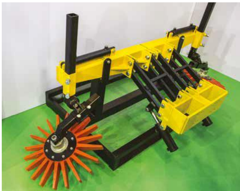
“IL PROTOTIPO PRESENTATO DA TECNOVICT A FIERAGRICOLA 2016 VIENE STAFFATO ANTERIORMENTE AL TRATTORE, ED È DOTATO DI 4 CILINDRI IDRAULICI PER LA REGOLAZIONE.”
