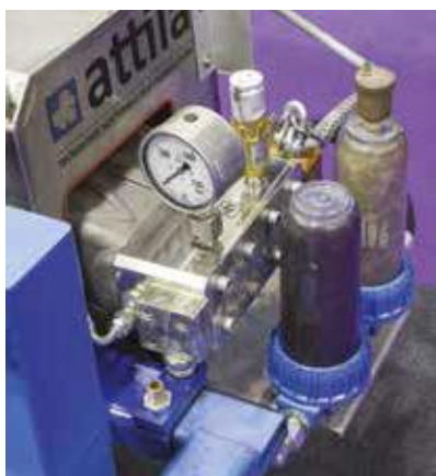
“LA DELICATA POMPA AD ALTISSIMA PRESSIONE RICHIEDE UN DISPOSITIVI DI FILTRAZIONE MOLTO ACCURATO, CHE SI BASA SU PIÙ STADI A DIVERSA MESH.”
