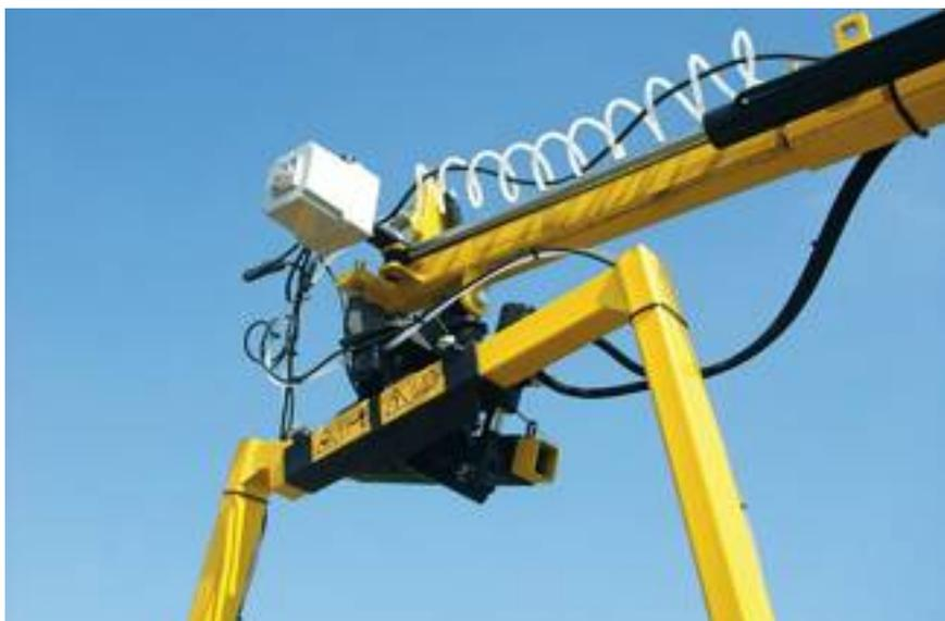
>> 2: Elettronica temporizzatore: il circuito permette di regolare l'inizio e la durata dell'apertura dell'ugello di irrorazione
