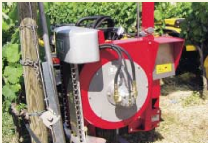
▲ Defogliatrice ad aspirazione da fessura seguita da organo di taglio a barra alternativa di taglio: notare la presenza anche di una barretta di taglio anteriore alla testata.
