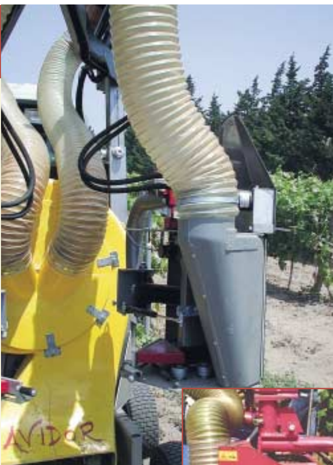
▲ ▶ Defogliatrice ad aspirazione da fessura seguita da organo di taglio a barra alternativa di taglio: aspirazione dell'aria attraverso tubi flessibili di grande diametro.
