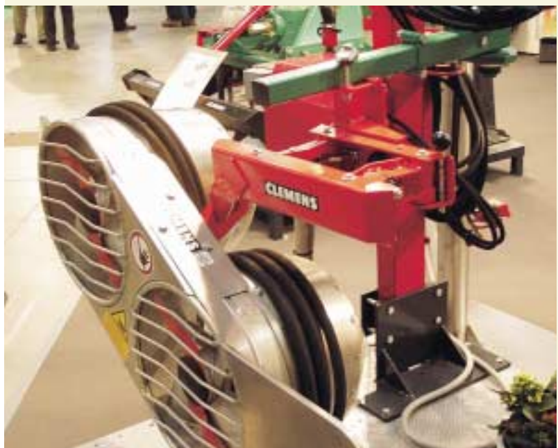
▲ Defogliatrice reversibile ad aspirazione a griglia e lame: doppia griglia di aspirazione orientabile per aumentare l'altezza di lavoro.
