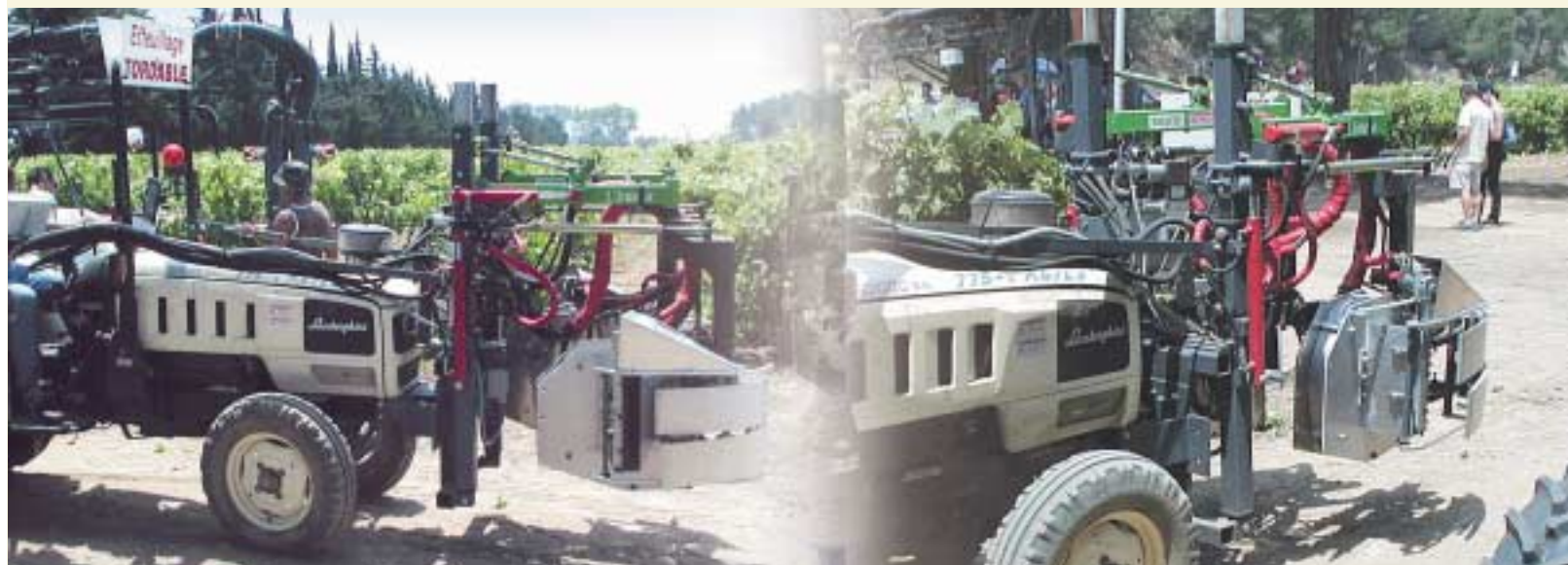
▼ Defogliatrice ad aspirazione da fessura seguita da organo di taglio a barra alternativa di taglio: dettaglio del sistema di palpatori in grado di rilevare l'inclinazione della chioma ed adeguare di conseguenza la posizione della testata.
