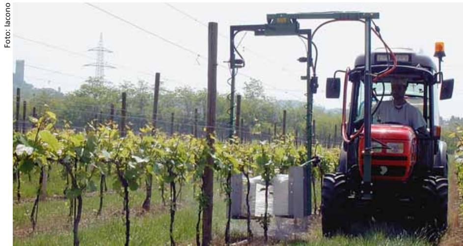
Foto 1 - Macchina operatrice in funzione: si può notare all'interno della testata una forte nebulizzazione del prodotto e la mancanza di un effetto deriva
