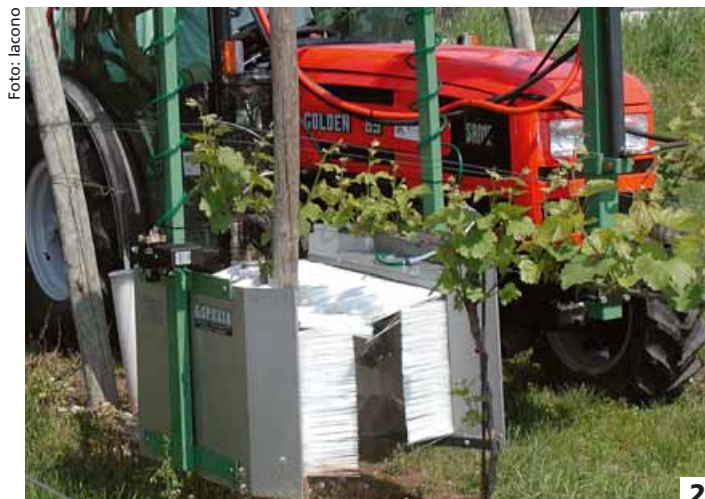
Foto 2 - Particolare della testata erogatrice. Foto 3 - Particolare dell'effetto bagnante pochi istanti dopo il passaggio della macchina
