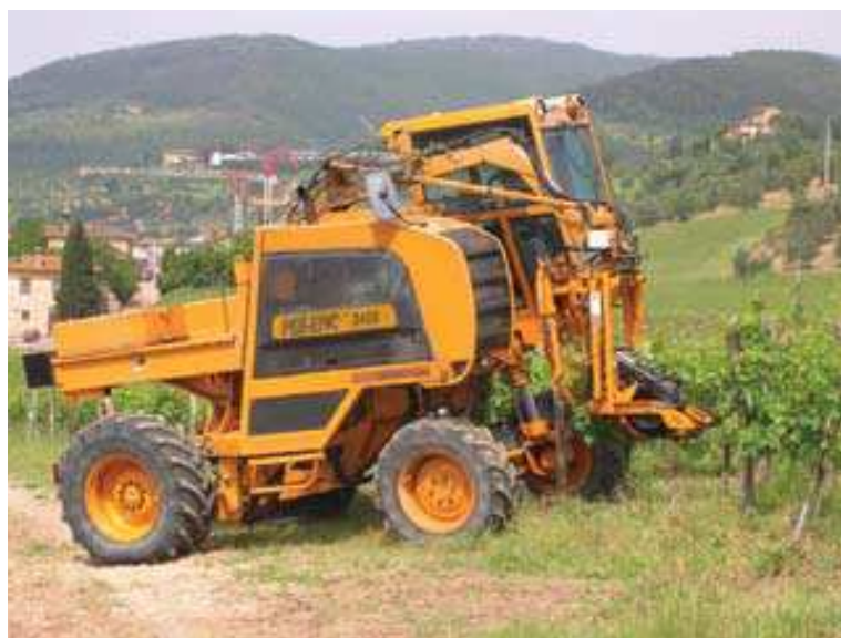
(F) - L'utilizzo del GPS può permettere di dividere il vendemmiato in funzione di parametri qualitativi, nei due cassoni che vengono scaricati separatamente ( Alma - Olmi )
