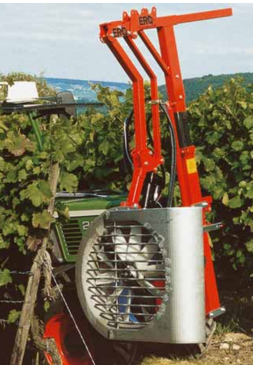
Sfogliatrice ad aspirazione a griglia e lame della Ero
