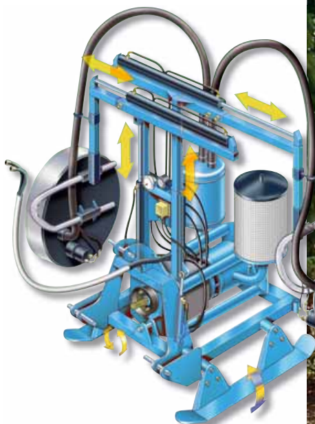
Versione pneumatica della Olmi che "soffia" le foglie a intermittenza a una pressione tale da sfibrarle
