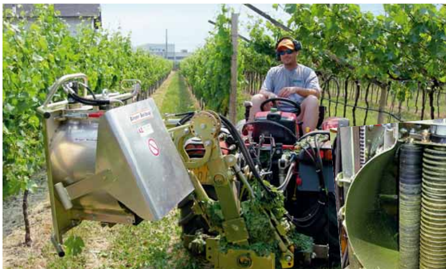
Sfogliatrice a strappo della Binger con evidenti a destra i due rulli verticali controrotanti
