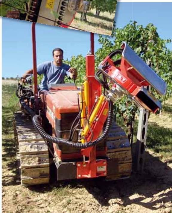
Defogliatrice a doppia lama della B.M.V. La testata reversibile permette di lavorare entrambi i filari. In alto è ben visibile la doppia lama di taglio
