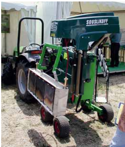
Defogliatrice termica a pannello radiante a combustione Gpl
