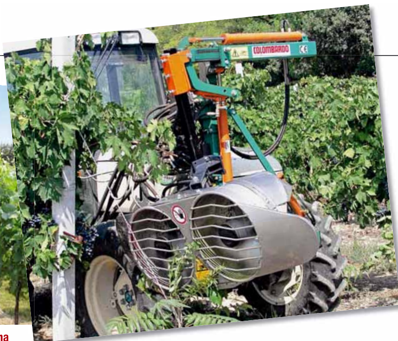
La doppia griglia di aspirazione orientabile della Colombaro permette di aumentare l'altezza di lavoro
