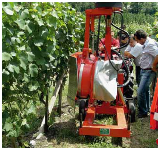
Defogliatrice ad aspirazione con testata a fessura seguita da barra di taglio della Olmi
