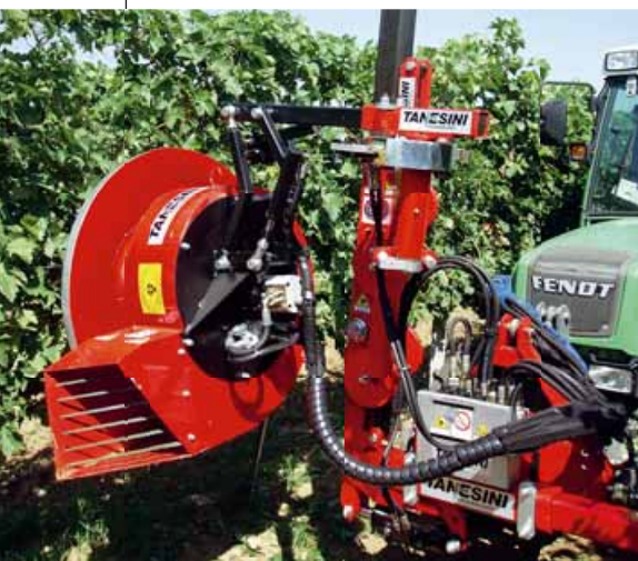
Defogliatrice della Tanesini ad aspirazione a griglia con taglio ottenuto da lame rotative
