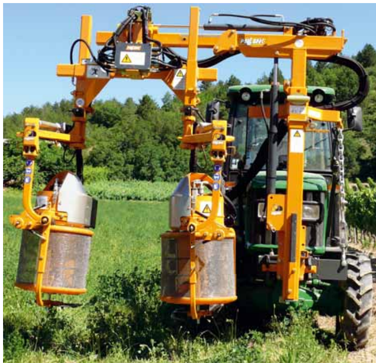
I tamburi rotativi della Pellenc si adattano alla vegetazione grazie alla rete deformabile esterna. Le foglie aderiscono al tamburo per aspirazione e poi staccate intere
