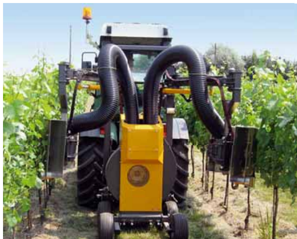
Il modello Dx della Gregoire aspira le foglie grazie a un sistema Venturi. Il flusso d'aria generato allontana poi le foglie recise dalla lama
