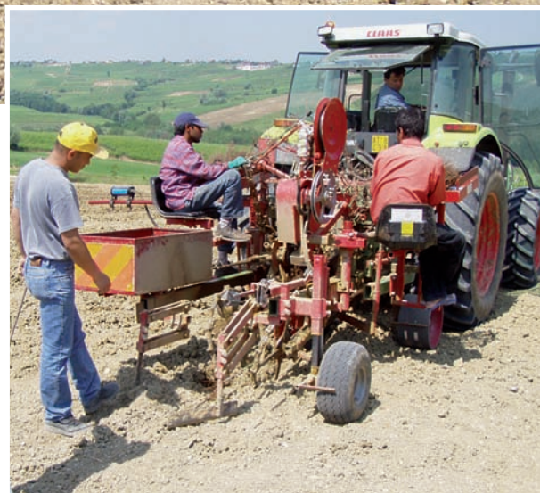
A fianco: Trapiantatrice Wagner: notare i due operatori a bordo per alimentare il distributore rotativo delle barbatelle.
