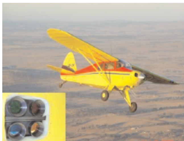
Fig. 15 - Sistema di immagine multispettrale a bordo di aeromobile. Nel particolare si identificano i quattro sensori di rilievo per i colori blu, verde, rosso e NIR. (UNEBird, University of New England, New South Wales)
