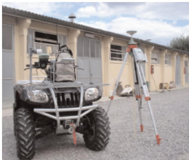
Fig. 16 - Laboratorio mobile per il monitoraggio culturale dei vigneti allestito dal DEISTAF di Firenze nella stagione 2009. Il laboratorio è provvisto di sensore di riflettanza CropCircle, computer di bordo 8" e sistema satellitare DGPS-RTK.
