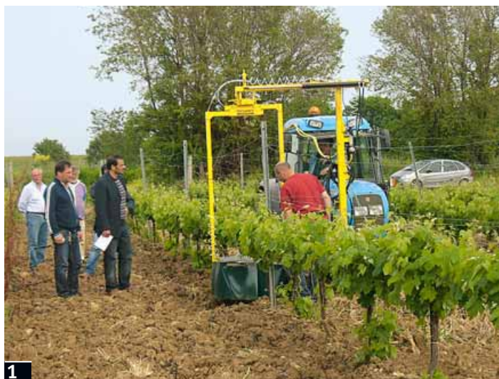
1. Messa a punto della macchina spollonatrice chimica in prova presso l'azienda agricola Roberto Catena, Cerveteri (RM). Foto Parente 2. Macchina al lavoro nel caso delle prove per determinarne la produttività. Foto Parente
