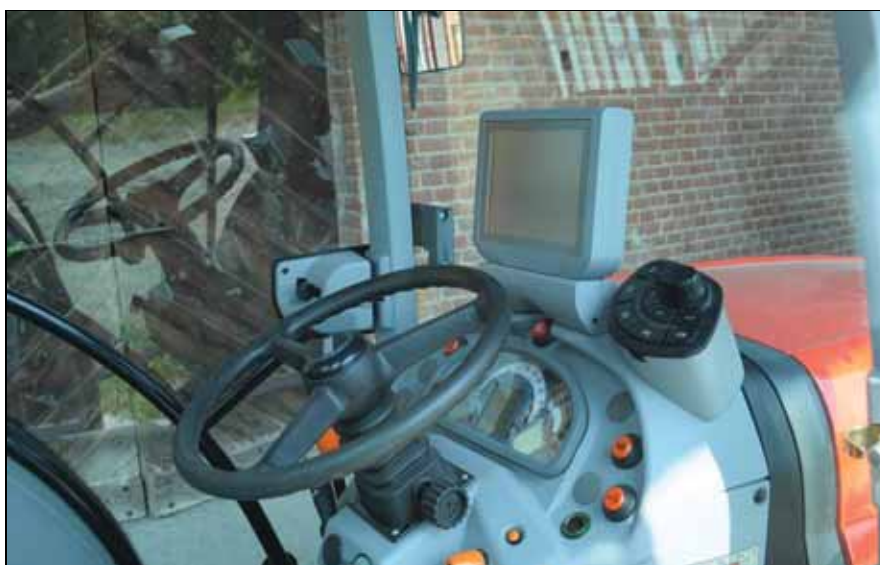
Cabina di guida con iMonitor e Task Controller
