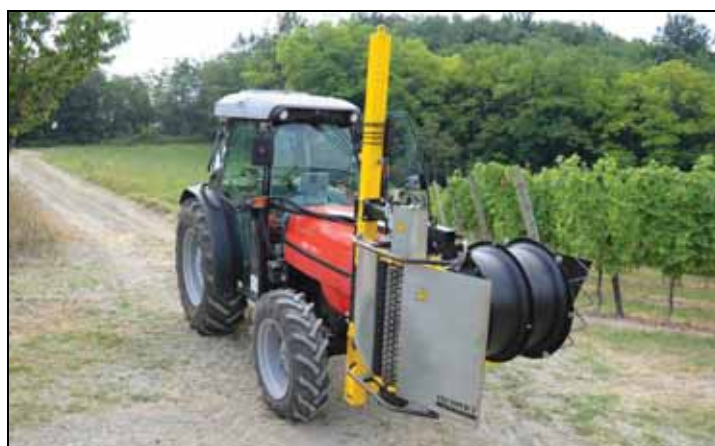
Defogliatrice a rulli Tecnoviet su trattrice SDF Frutteto 3 90
