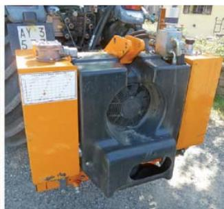
A sinistra: la defogliatrice Tecnovict 111 AA (ad Accostamento Automatico) montata in posizione latero-anteriore ad un trattore da vigneto; a destra: sul retro del trattore, l'impianto idraulico che alimenta tutti gli azionamenti della defogliatrice.
