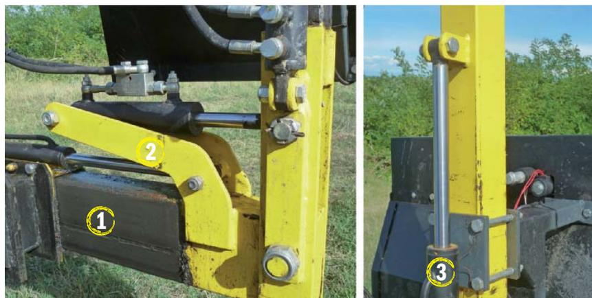
Regolazioni idrauliche della defogliazione Tecnovict 111 AA: 1 - accostamento automatico; 2 - inclinazione della testata nel piano verticale; 3 - distanza da terra della fascia di intervento.
