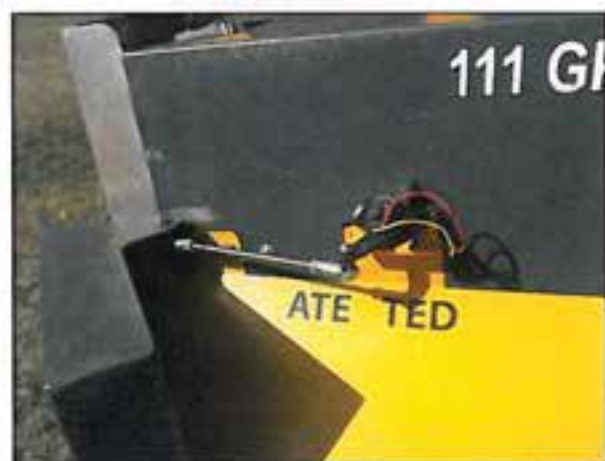
Sensore di posizione della palpebra sensibile
