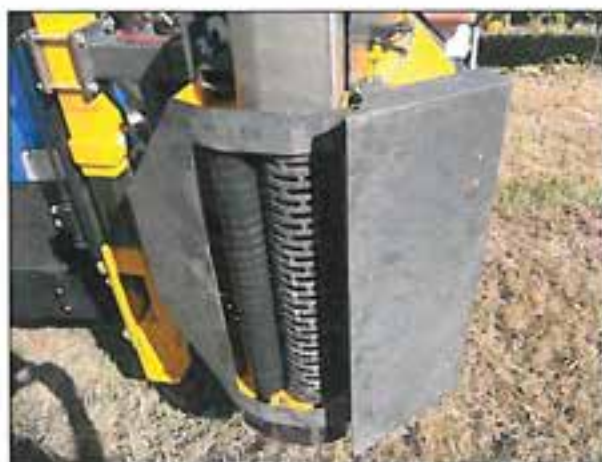
Apparato di strappo a rulli con palpebra sensibile
