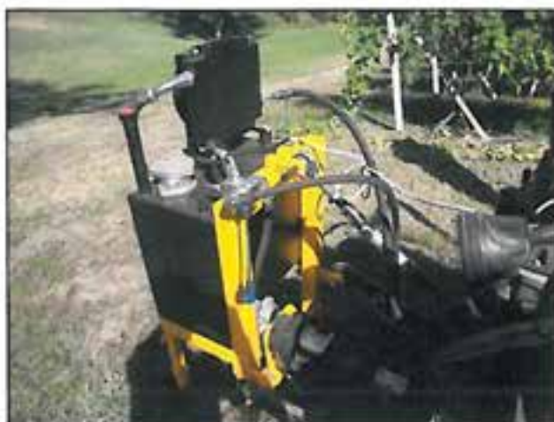
Serbatoio olio idraulico e scambiatore di calore
