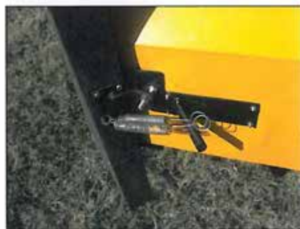
Sistema di richiamo della palpebra sensibile
